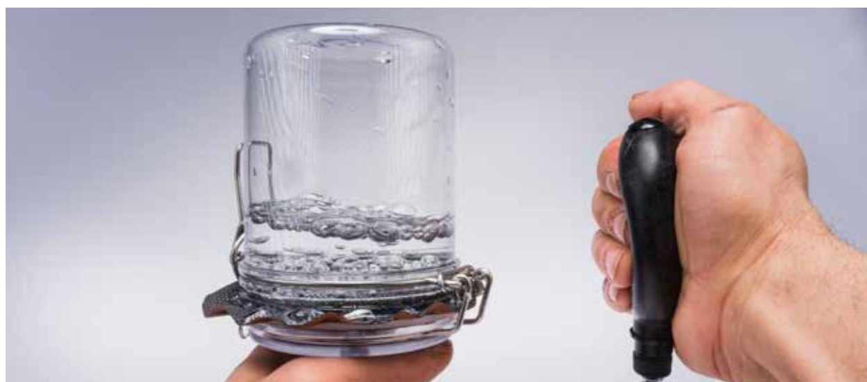
Un simple test montre comment fonctionne l'ancienne technologie. L'écran possède des micropores (petits trous) à travers lesquels l'air circule. Si la tension de surface des gouttes d'eau diminue, il peut perdre de son étanchéité à l'eau venue de l'extérieur.
